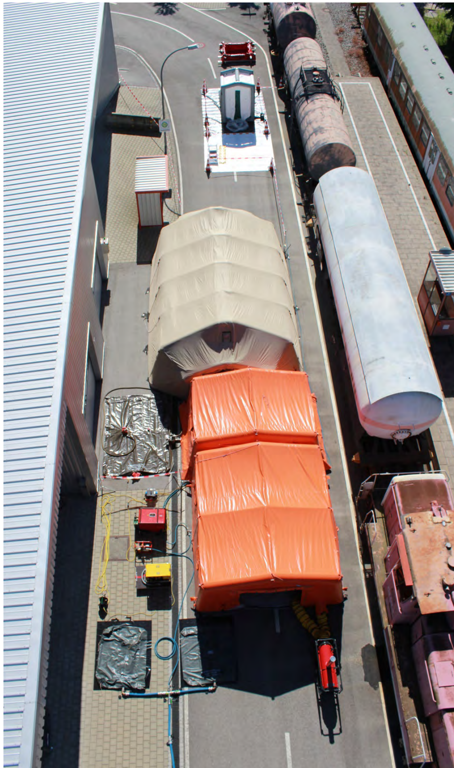
Abbildung 31: von unten: Trinkwasserfaltbehälter, Zeltheizgerät, Technikbereich, Ankleidezelt, 5000 l Abwasserbehälter, Duschzelt, Dekon V-Zelt, Standarddekonplatz mit Einzelpersonenduschkabine, provisorischer Abwasserbehälter (vgl. Abbildung 24).
