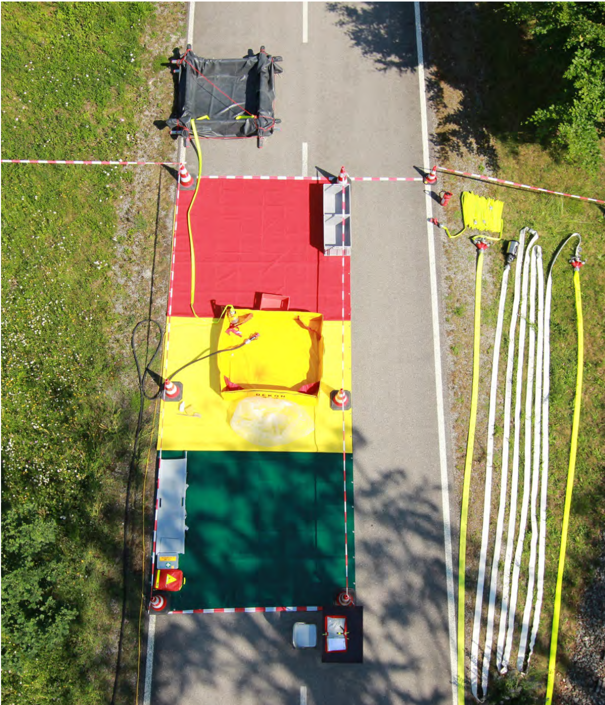
Abbildung 18: Standarddekonplatz nach dem Ampel-Prinzip; Erste-Hilfe-Material, Dekonwanne mit Tauchpumpe, provisorischer Abwasserbehälter, Stiefelvorreinigung, Geräteablage, Dokumentation, Tisch und Sitzgelegenheit.
