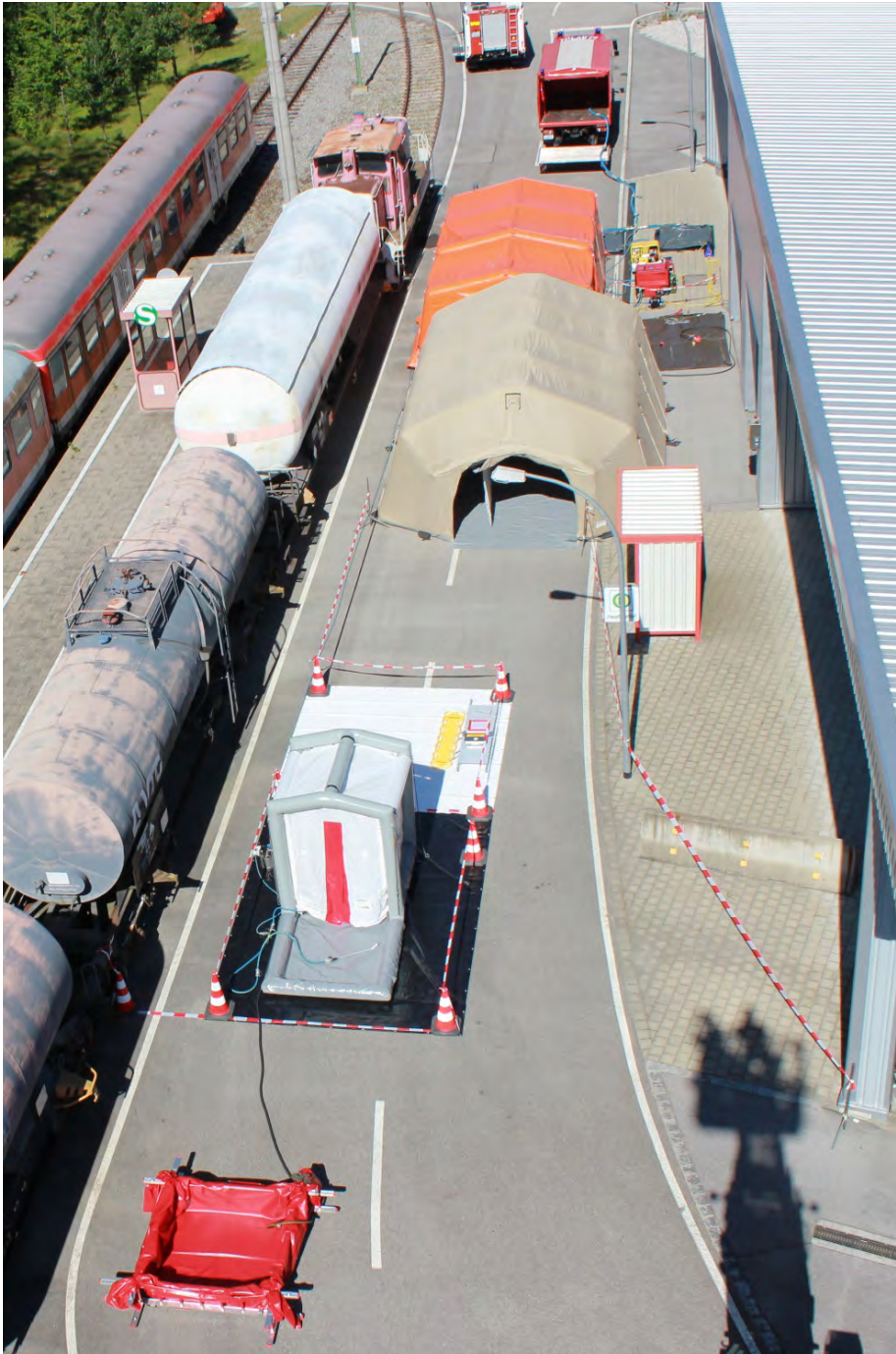
Abbildung 30: von oben: GW Dekon P mit Trinkwassertanks, Trinkwasserfaltbehälter, Ankleidezelt, Technikbereich, Duschzelt, 5000 l Abwasserbehälter, Dekon V-Zelt, Standarddekonplatz mit Einpersonenduschkabine, provisorischer Abwasserbehälter (vgl. Abbildung 24).
